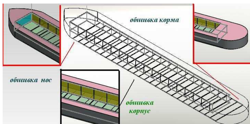
Рис.8. Трюмовый отсек в корпусе
