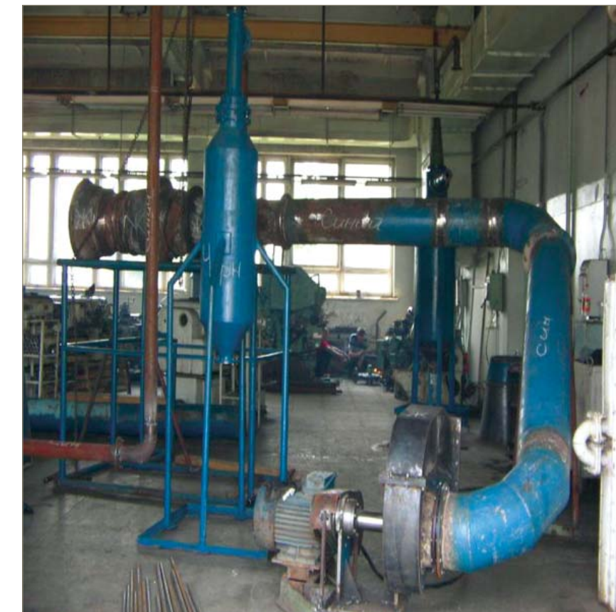
Рис. 6. Фото промышленной установки инерционно-вакуумного пылеуловителя
